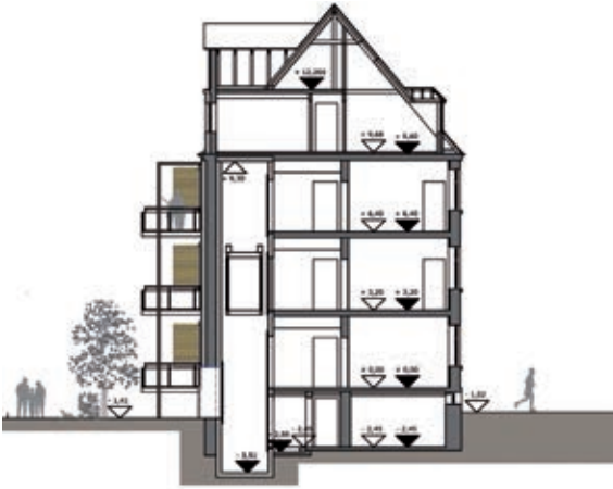
Schnitt mit innenliegendem Aufzug, ausgebautem Dachgeschoss und vorgestellten Balkonen.
